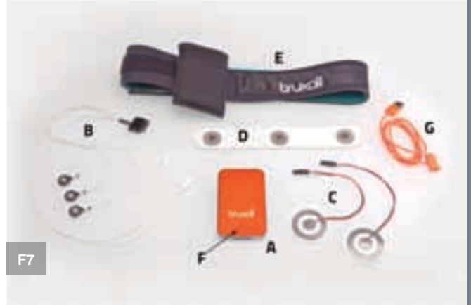
Fig. 7. A: Dispositivo Bruxoff®; B: cables de conexión de los electrodos; C: electrodos EMG; D: electrodo cardíaco; E: cinturón torácico; F: botón start/stop; G: cable USB para traspasar los datos al ordenador.
